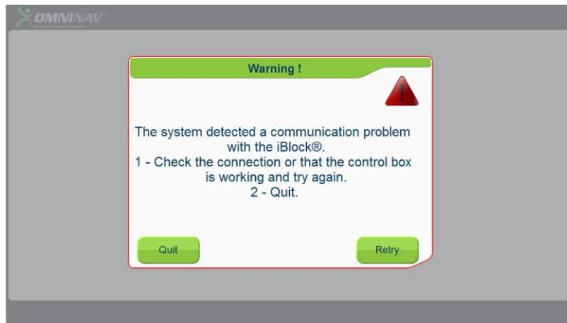
Verifique que a caixa de ligações está corretamente ligada à estação de ancoragem do computador portátil, assim como o OMNIBot (USB). Verifique que a luz de indicação de energia da unidade do motor está acesa.
